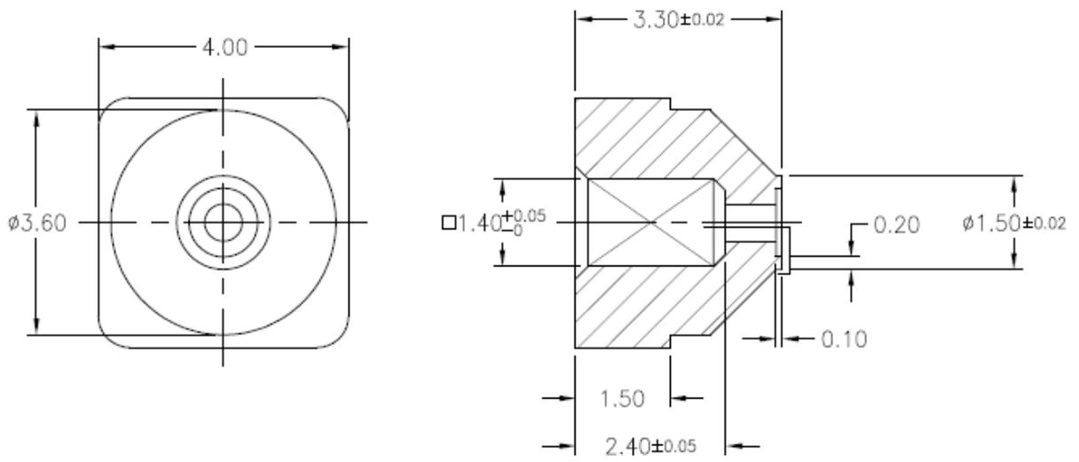
материал изготовления NBR - бутадиеннитрильный каучук
